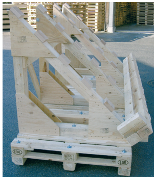
Transportgestell zur Lagerung von Glasscheiben.
